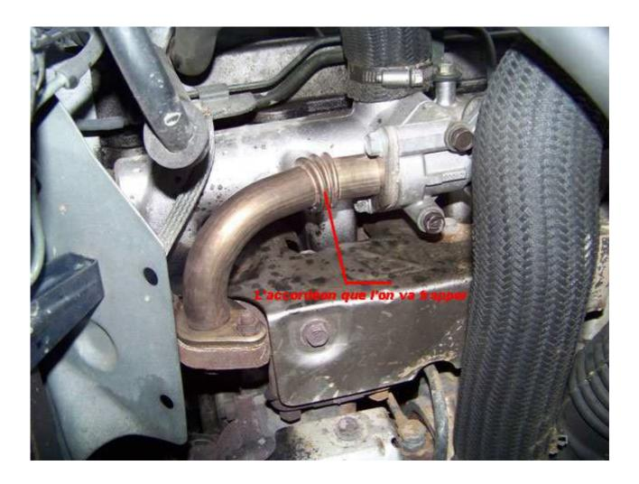
Pour cela, après avoir démonter le tuyau coudé, placer le en porte à faux entre deux planches ou les mâchoires d'un étaux, enfin ce que vous avez sous la main, afin de pouvoir placer un coup de marteau sur l'accordéon du tuyau, a l'emplacement de la flèche.
