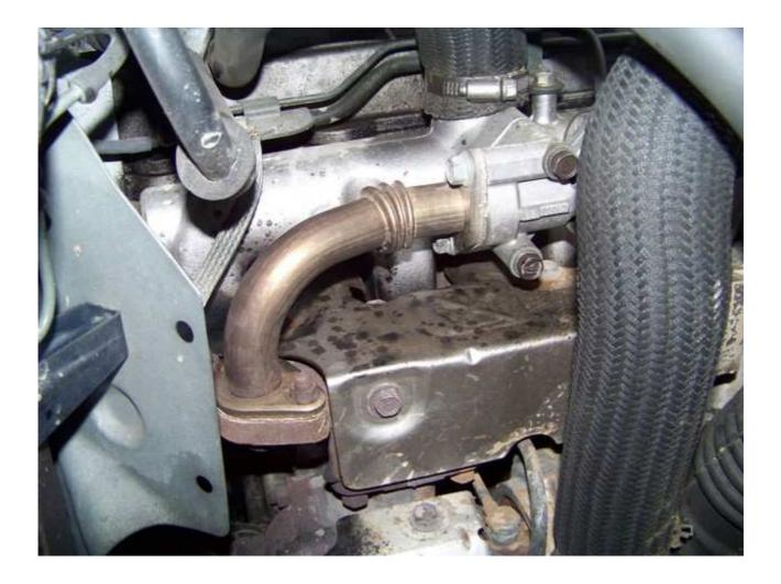
La vanne EGR entourer en Rouge, et le tuyau coudé qui va de la pipe d'échappement à la vanne EGR.
