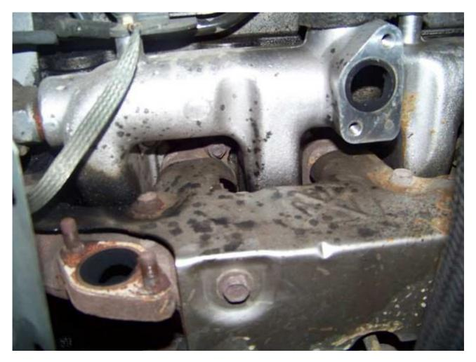
La les tubulures sont assez propre pour un remontage sans nettoyage.
